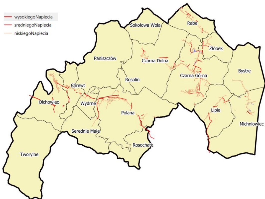
Rys. 34 Sieć elektroenergetyczna w gminie
